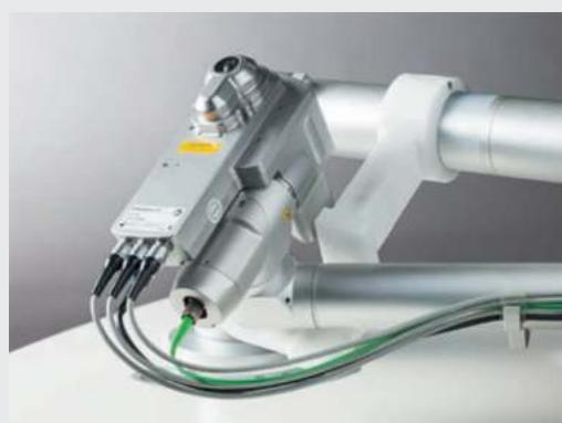
Энергия лазера доставляется в роговицу через рукоятку, имеющую встроенную сканирующую систему и камеру высокого разрешения (HD).
